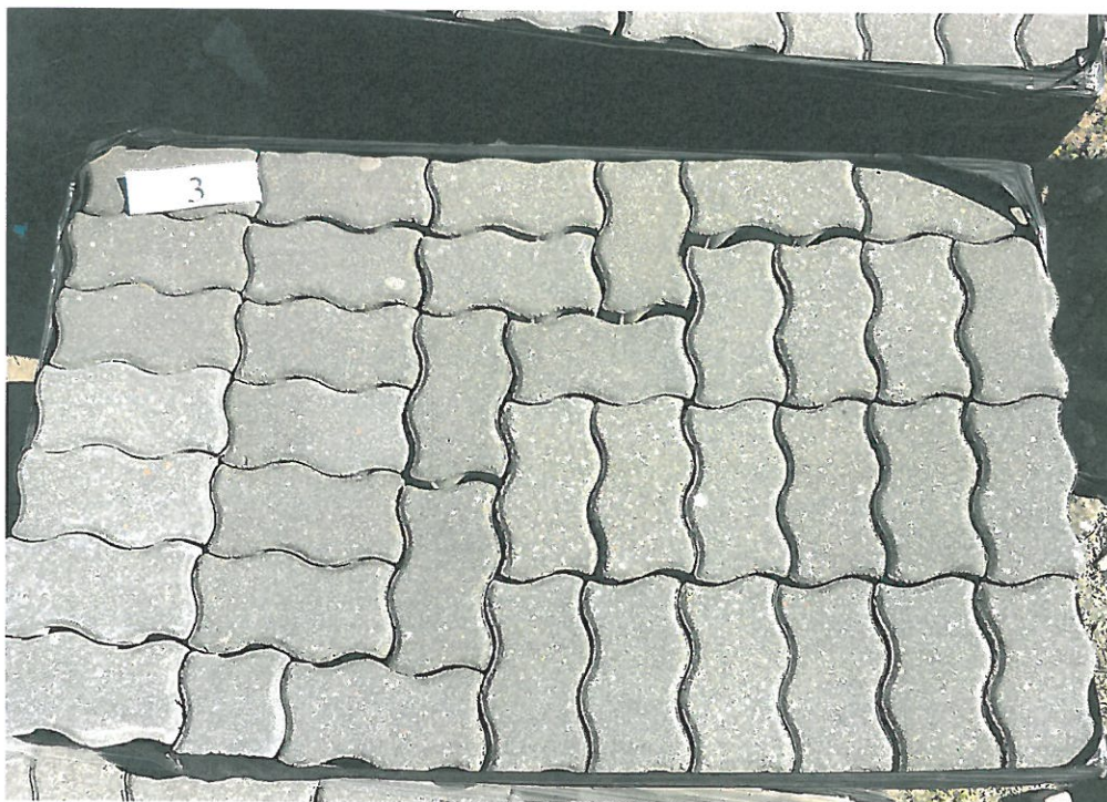
Część nr 3 Kostka grafit fala 6 cm - 244,01 m 2 - oznaczona dodatkowo na zielono na ofoliowaniu
